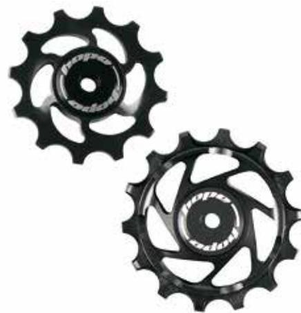
La roldana superior tiene un perfil de 12 dientes convencional para que el cambio sea suave mientras que la roldana de 14 dientes inferior tiene un perfil ancho/estremo para asegurar que la cadena se ajusta perfectamente. Las 2 roldanas están fabricadas en aluminio y llevan rodamientos de sellados.
