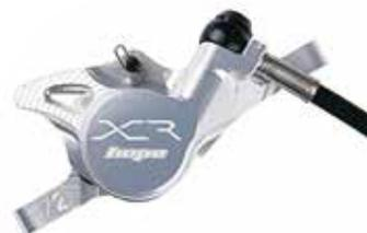
La palanca XCR Pro es lo último en diseño y ligereza. Con una palanca de carbono y tornillería de titanio, combinados con una pinza XCR X2, será el freno XC de referencia.
