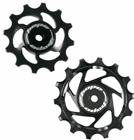
La roldana superior tiene un perfil de 12 dientes convencional para que el cambio sea suave mientras que la roldana de 14 dientes inferior tiene un perfil ancho/estrecho para asegurar que la cadena se ajusta perfectamente. Las 2 roldanas están fabricadas en aluminio y llevan rodamientos de sellados.
